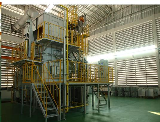
溶解炉 (ADC12 集中溶解炉+溶解保持炉)
